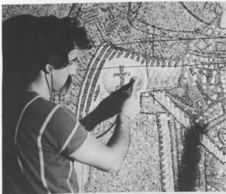
Foto N°3: Sistema di rilevamento ad oscultazione facendo oscillare la frequenza di un diapason sulla superficie del mosaico.
