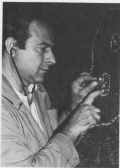
Figure 1. Prima di iniziare il consolidamento del manto musivo e dei suoi supporti, è bene rilevare il degrado, punto per punto, delle aree del distacco, ovvero individuarle a mezzo dell'auscultazione, con l'ausilio di apparecchio stetoscopico. La diagnosi sarà della compresenza di tutti i tipi di distacco.
