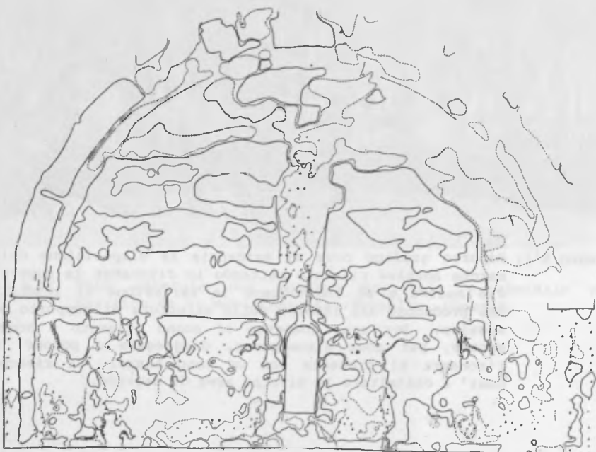
Disegno N°3: Grafico di congiunzione di tutte le marche adesive, per l'ottenimento della mappa delle alterazioni, in questo sono riportate le lesioni e le fratture presenti (linee tratteggiate aperte) e le grappe superficiali (triangoli neri).
