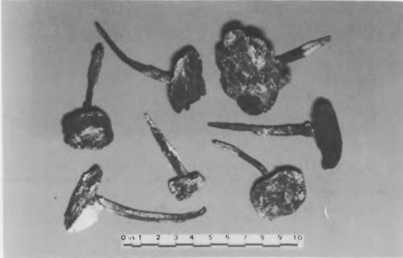
Fig. 4. - Chiodi di ferro rinvenuti negli intradossi di alcuni sottarchi.
