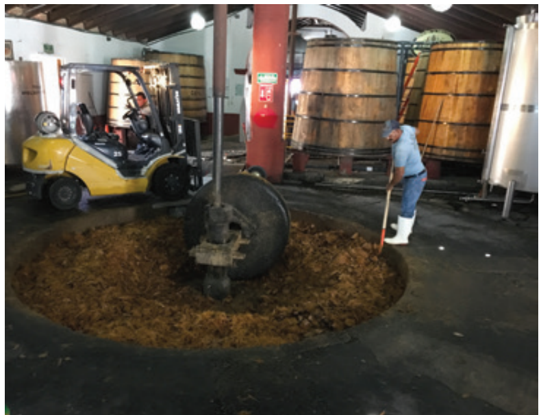
En el proceso tradicional de producción del tequila se realiza la molienda del agave cocido para la extracción de los jugos por medio de la tahona o molino de piedra. Destilería la Fortaleza en Tequila.
