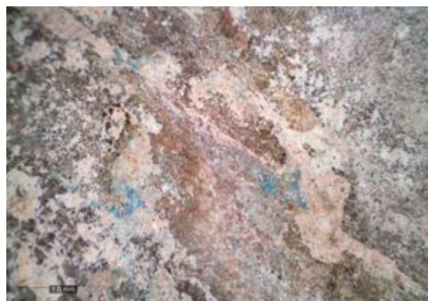
3 Drei blaue Farbspritzer im Bereich der südwestlichen Sinopie, 2018, Digitalmikroskopaufnahme in situ mit 20-facher Vergrößerung
