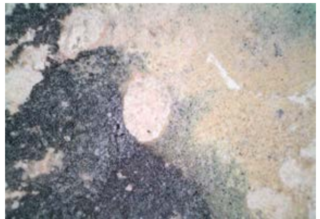
10 Farbschichten von Ocker, Grün und oxidiertem Kupfergrün, 2019, Digitalmikroskopaufnahme in situ, Erdgeschoss, Südseitenschiff
