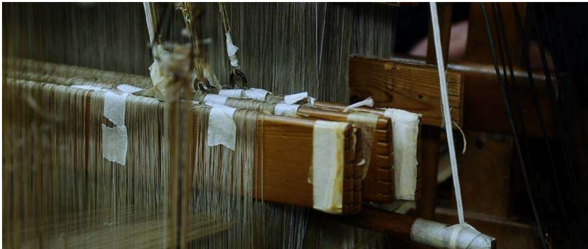
Fig. 2 Lizos de un telar Jacquard. Fábrica Garín 1820
