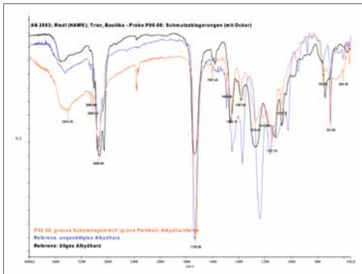
Abb. 6-3: FTIR-spektroskopische Analyse einer Mikroprobe eines weiteren Überzugs auf der Malerei (grünliches Alkydharz, Vergleichsspektren rezenter Alkydharze)
