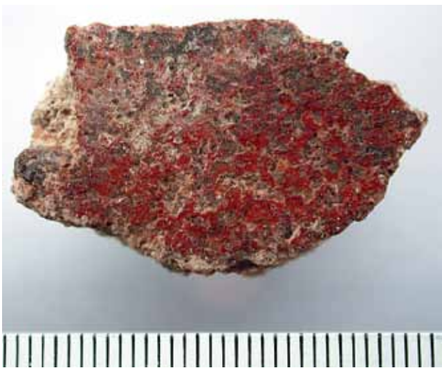
Abb. 4-9: Struktureller Aufbau des römischen Mörtels im Anschlag
