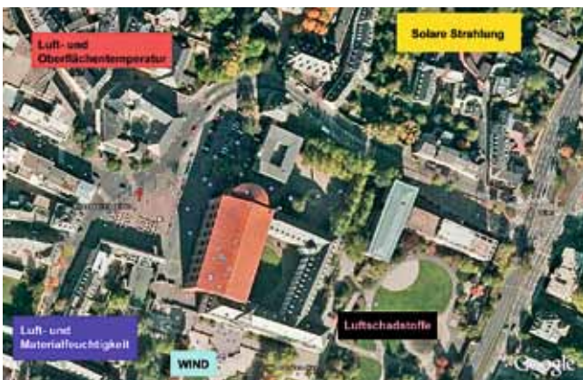
Abb. 7-15: Die bauliche Situation um die Konstantinbasilika, Luftaufnahme und schematische Darstellung des klimatischen Einflusses
