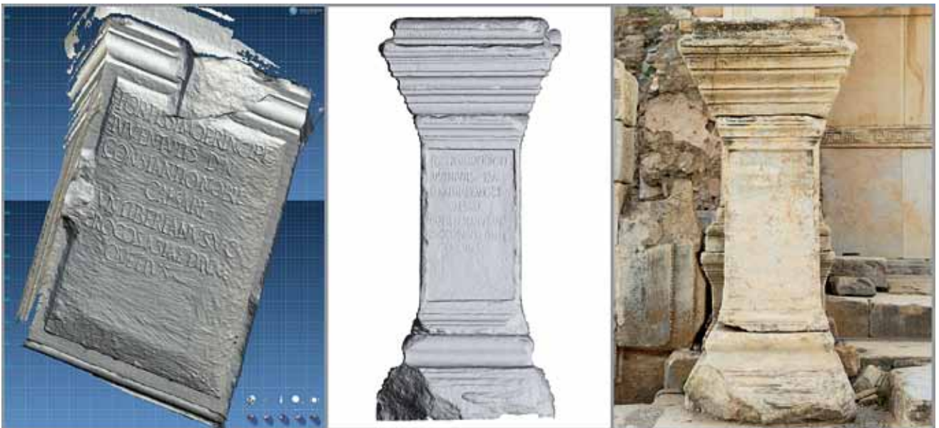
Abb. 15-5: Aufnahme eines Statuenpostaments mit einem Streifenlicht-Scanner: (a) Einzelscan, (b) fertiges 3D-Modell, (c) Foto
