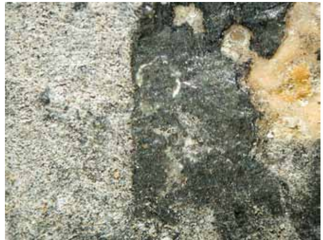
Abb. 10-11d: Reinigungsprobe am Bruchstück unter Mikroskop; linke Bildseite: Vorzustand, die Gipskruste stellt sich als weiße kristalline Auflagerung dar; rechte Bildseite: Reinigungsprobe; Bildhöhe ca. 4 mm
