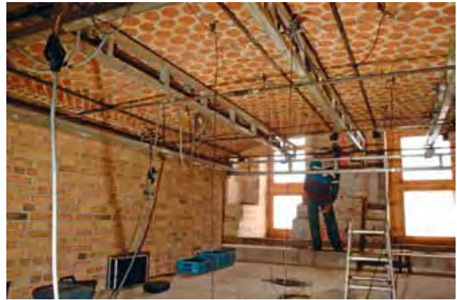
Belastungsuntersuchungen an einem Probegewölbe aus Tontöpfen.
