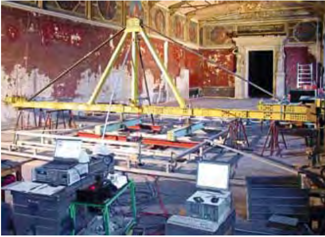
Niobidensaal, Belastungsuntersuchungen vor und nach der Verstärkung der Eisenguss-Träger. Зал Ниобидов, испытания под нагрузкой до и после укрепления чугунных балок.
