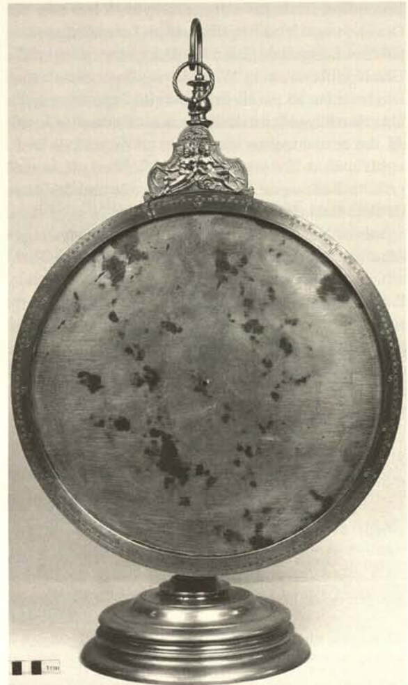
10 Fleckpatinabildung auf einem Astrolab in Messing (Germ. Nat.-Mus. Nürnberg) Derartige Flecken sind nur durch einen tiefer wirkenden Eingriff zu beseitigen.
