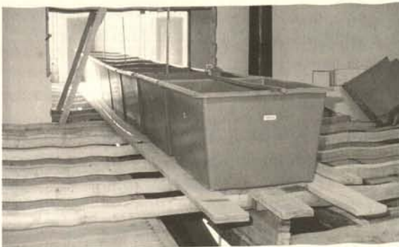
10 Tübingen, Schloß Hohentübingen, Nordflügel: Probelastung der Sprengwerksdecke mit Wasserbottichen
