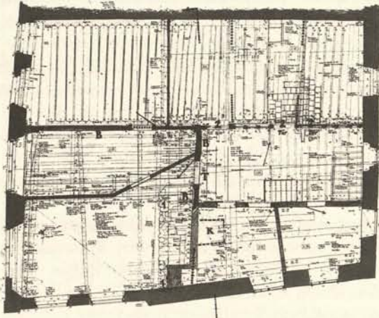
15 Kempten, Schützenstr. 11, Bestandsgrundriß des 2. OG mit baugeschichtlicher Bewertung
