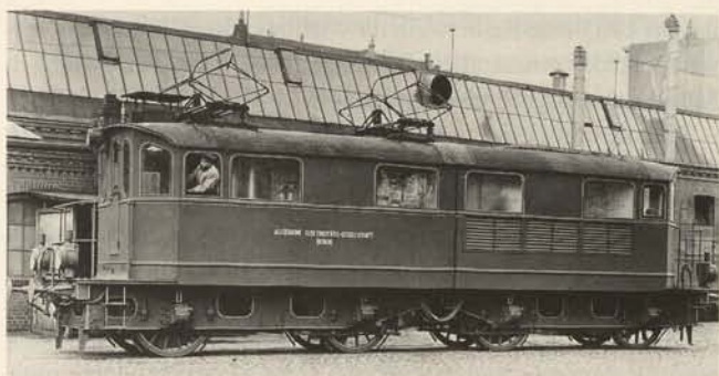
Abb. 67. Erste Einphasen-Wechselstrom-Lokomotive der AEG, getestet auf einer Versuchsstrecke bei Oranienburg (Berlin), im Einsatz bei der Hamburger Hafenbahn (Baureihe E 73; 1907).
