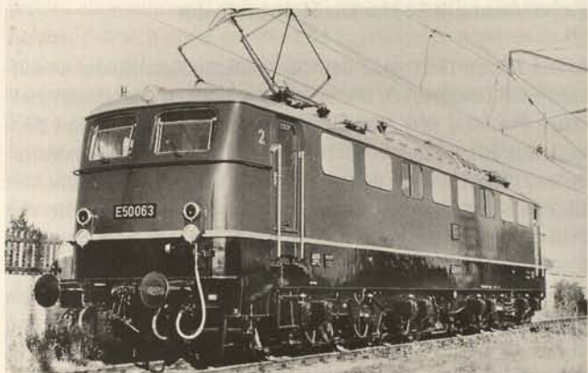
Abb. 68. Schwere elektrische Güterzuglokomotive der Deutschen Bundesbahn (Baureihe E 50; 1957).
