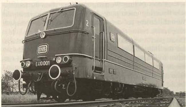
Abb. 69. Erste Viersystem-Lokomotive der Deutschen Bundesbahn für den grenzüberschreitenden Verkehr mit Frankreich, Belgien und den Niederlanden (Baureihe E 410; 1966).
