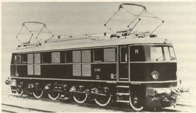
Abb. 73. Hochgeschwindigkeitslokomotive der AEG, Höhepunkt der Vorkriegsentwicklung für Spitzengeschwindigkeiten von 225 km/h (Baureihe E 19; 1938).
