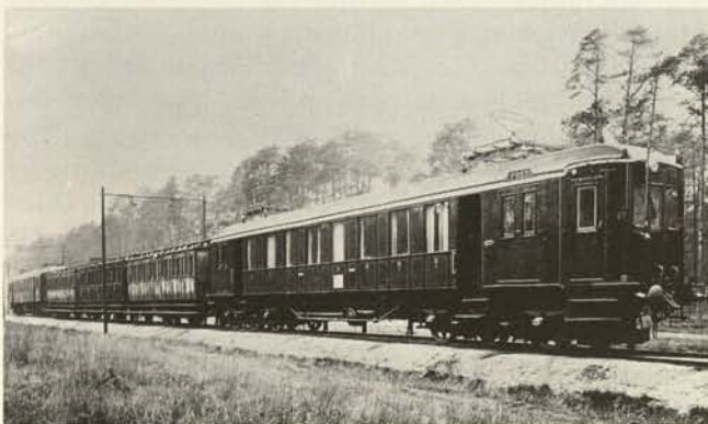
Abb. 66. Einphasen-Wechselstrombahn der AEG zwischen Niederschöneweide und Spindlersfeld bei Berlin (1903).
