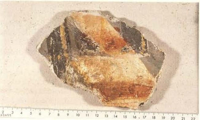
Abb. 247. Reichenau-Mittelzell, Münster, Mörtelfragmente (12/1/L und 37/52/L) aus der Grabung Reisser mit mehrschichtigem, einphasigem Fassungs Aufbau über versinterter Oberfläche: ornamentale Kalkmalerei (?) in grau-grün, hellrot, ockerrot und weiß (1995).
