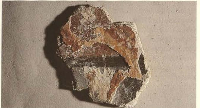
Abb. 249. Reichenau-Mittelzell, Münster, Mörtelfragment (1/25/C) aus der Grabung Reisser mit mehrschichtigem Fassungs Aufbau verschiedener Phasen: auf dem Mörtel freskale (?) Malschicht und drei Tünchen mit Fassung (1995).
