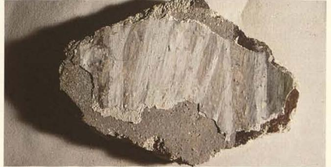
Abb. 248. Reichenau-Mittelzell, Münster, Mörtelfragment (13/35/C) aus der Grabung Reisser mit mehrschichtigem Fassungs Aufbau verschiedener Phasen: freskale (?) Malschicht und Tünche mit Zeichnung (1995).
