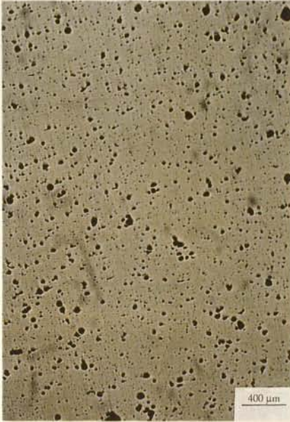
1. # CHTG2(B): ungeätzt (Bild: SAA3/6)
