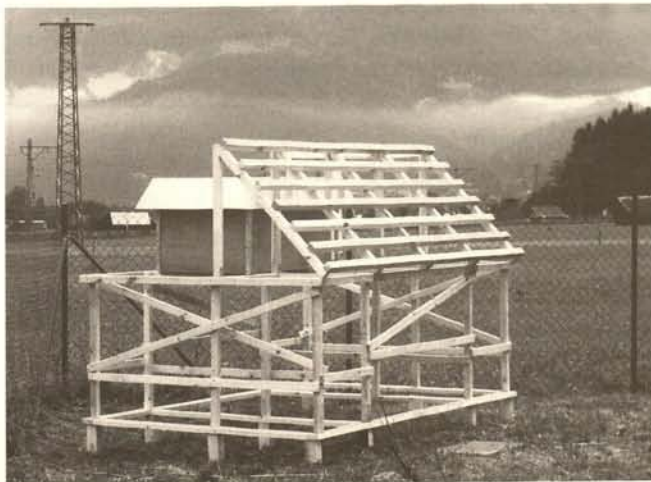
Abb. 2. Expositionsgestell bei Garmisch. Der Kasten ist unten offen und besitzt unter dem Vordach breite Lüftungsschlitze
