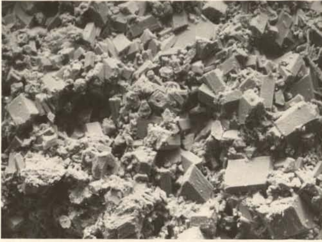
Abb. 3. Rasterelektronenmikroskopische Aufnahme eines Korrosionsproduktes von der Skulptur des Feldherrn Tas
