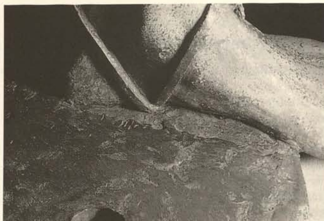
Abb. 3. Überfangguß erstarrte vor Erreichen der Fußsohle
