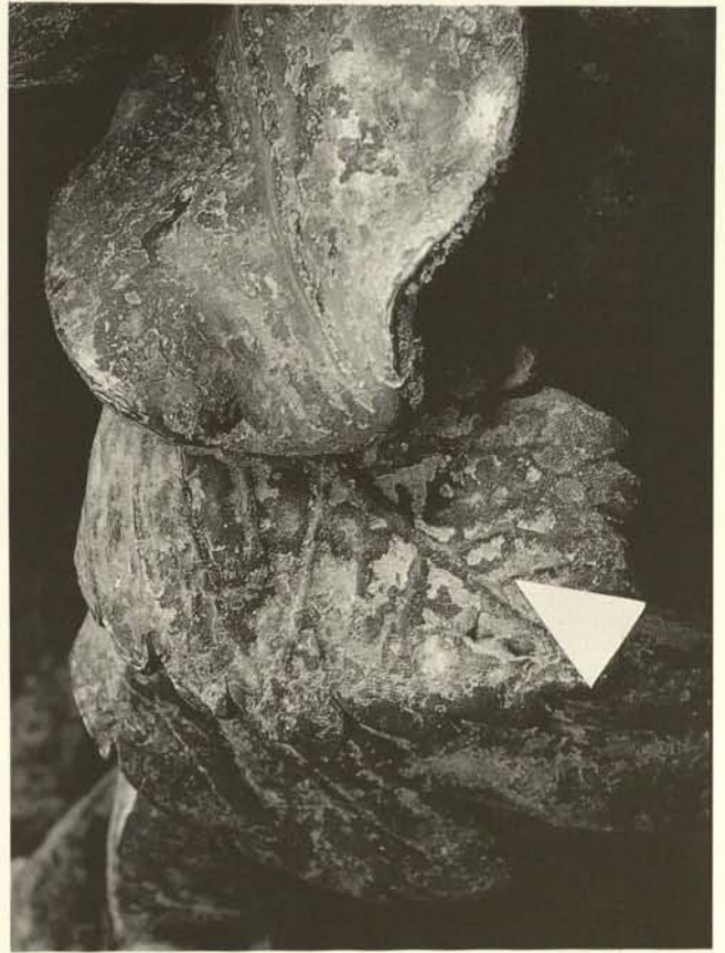
Abb. 3. Die aufliegende schwarze Kruste enthält vom Herstellungsprozess herrührende Bearbeitungsspuren
