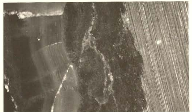
Abb. 5. Pfarrkirche Aldersbach, Chorgestühl, Zinnornament (18. Jh.); Querschiff, korrosive Umwandlung des Metalls bis über die Hälfte der Materialdicke zu Zinnoxiden; im Bild ist die gesamte Dicke des Ornaments dargestellt; Bildhöhe = 0.56 mm
