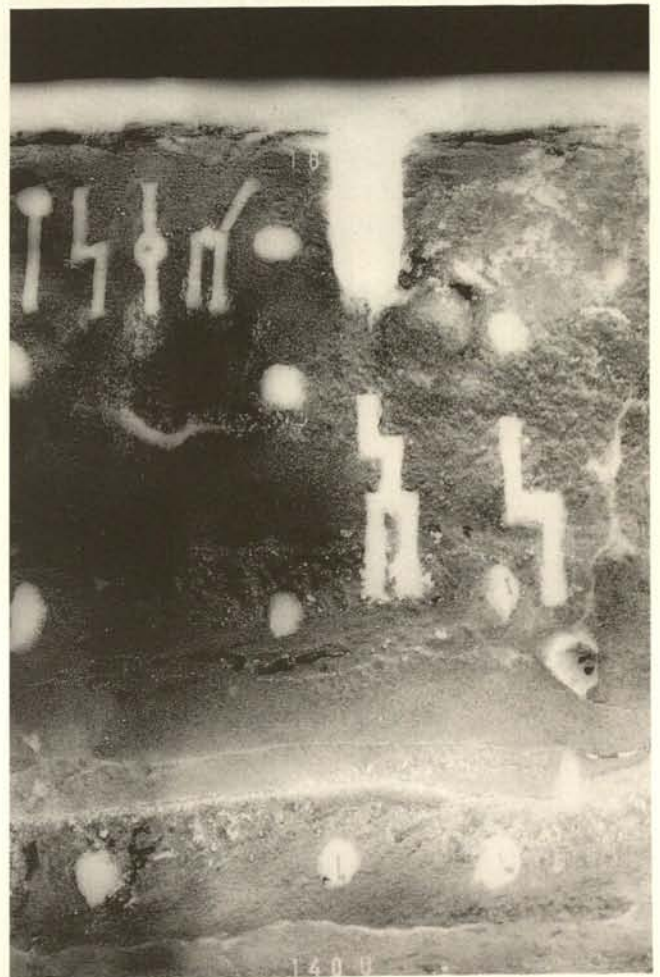
Abb. 2. Röntgenbild der Kesselwandung mit Schichtstrukturen und Linien in den Noppen
