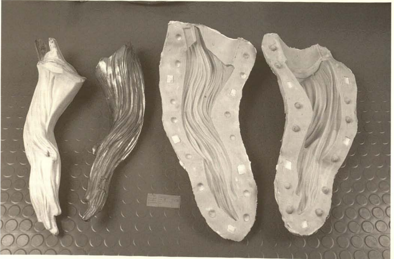
Abb. 7. Gipsmodell, Silikonabformung und Bronzenachguß für die Rekonstruktion des Pferdeschweifs am Denkmal Friedrich Wilhelms IV.
