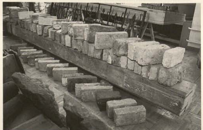
Abb. 2. Auswahl verschiedener Mauerziegelformate.
