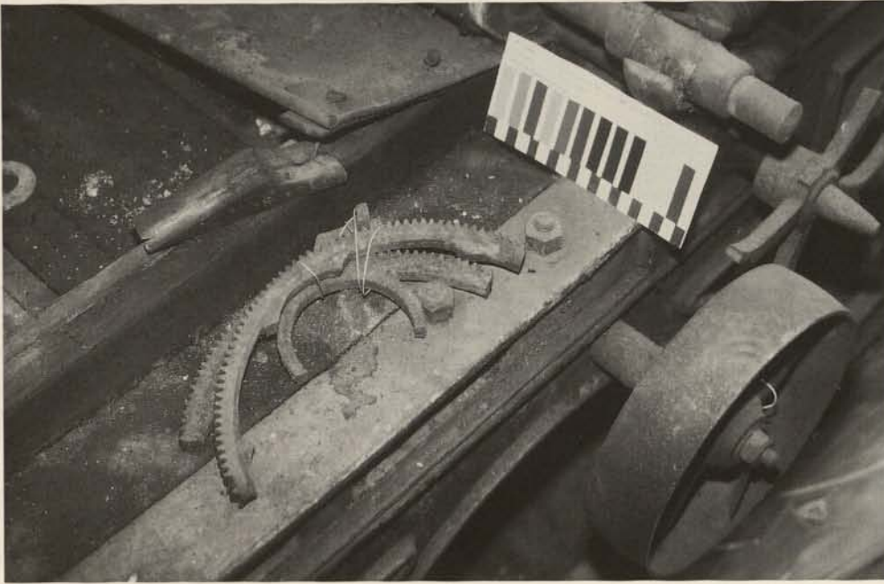
Abb. 9. Bei Maschinen mit dem Restaurierungsziel „Stilllegung“ wurden zerbrochene Zahnräder nicht wieder zusammengefügt.
