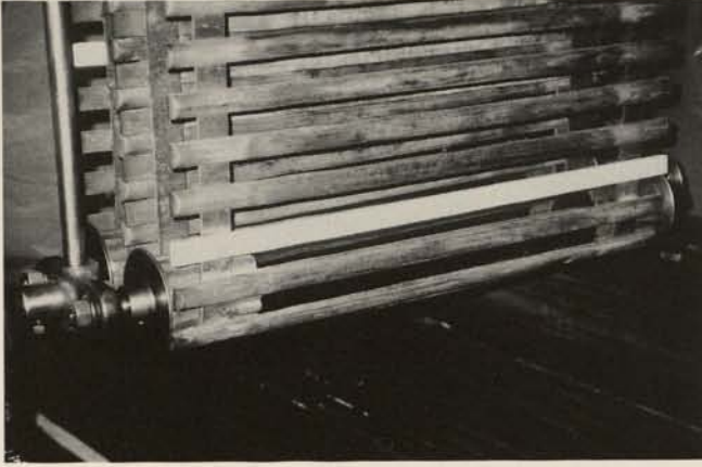
Abb. 3. Ergänzte Holzleiste an einem Transportband für Wollvlies. Die Ergänzung wurde materialgerecht ausgeführt, aber nicht retuschiert, weil der Alterungston des ergänzten Holzes sich schon bald harmonisch in die gealterte Umgebung einfügen wird.
