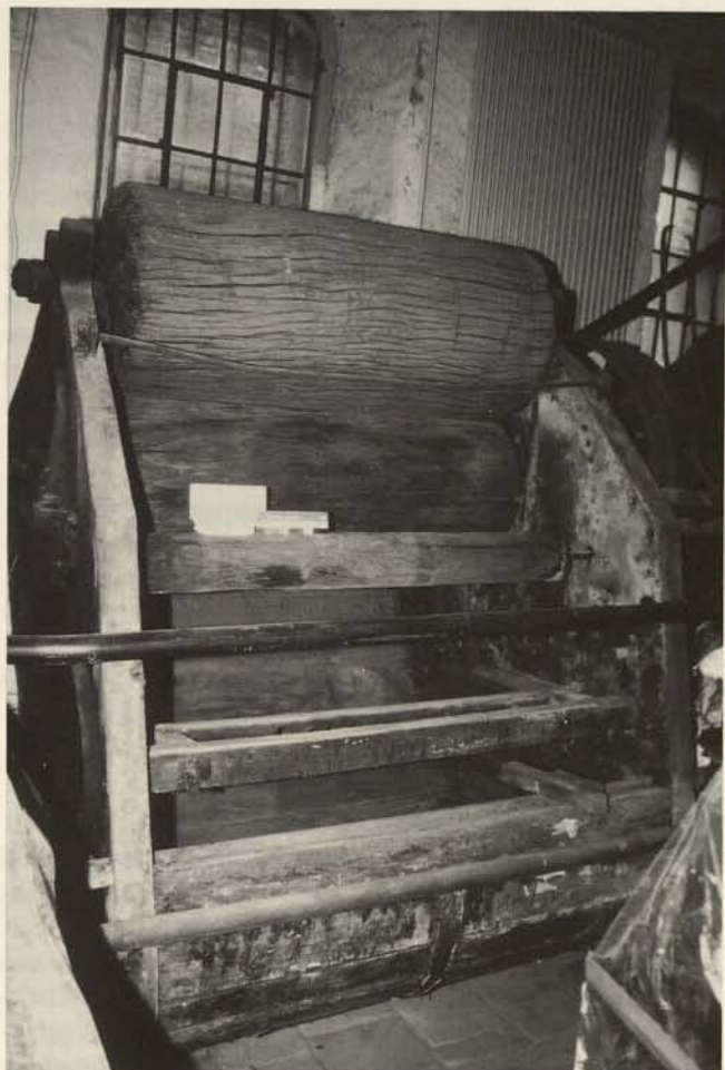
Abb. 10. Die Objekte in der Naßappretur wurden im Übernahmestand erhalten. Das bedeutete neben der Erhaltung von Gebrauchs- und Stilllegungsspuren auch die Konservierung der Verfallsspuren, die nach 1961 bis zum Beginn der Inventarsanierung 1996/97 aufgetreten waren.
