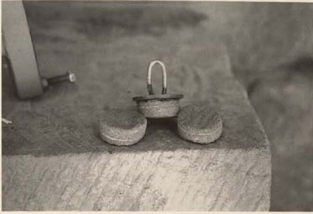
Abb. 6. Haftzugmessung. Stempel nach Bruch in der Ersatzmasse Fig. 6. Measurement of adhesion properties. Stamp after fraction within the filling substitute
