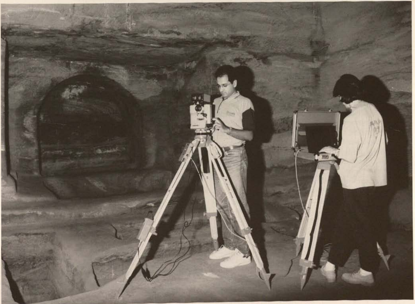
Abb. 1. Arbeit mit der Totalstation on-line mit dem Computer / Fig. 1. Working with total station connected on-line to the computer
