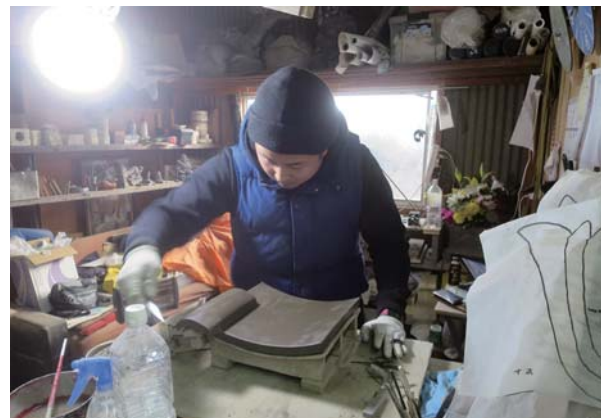
写真 2.2.14 補足する目板瓦製作の様子
