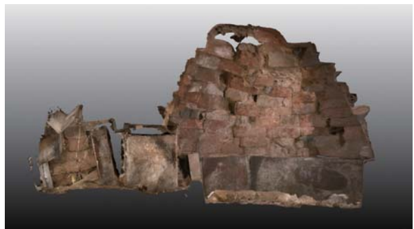
写真 2.19.2 井寺古墳 三次元計測による石室の被災状況 左：南側、右：北側（嘉島町教育委員会提供）
