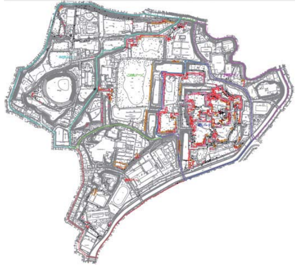
図 2.1.1 平成28年熊本地震での熊本城跡の石垣被災箇所図
