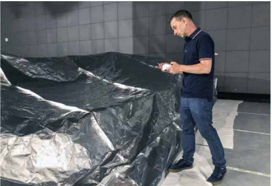
Fig3. Entomologist Bill Landsberger (Rathgen-Forschungslabor) monitors oxygen concentration in the anoxic tent, Ethnologisches Museum Berlin, Stiftung Preußischer Kulturbesitz
