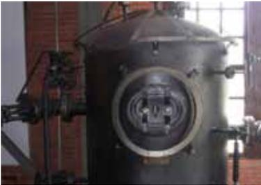
De la Maschinenfabrik Augsburg Nürnberg de Alemania las dos calderas de vapor fueron adquiridas en 1932 a través de la casa de contratistas e importadores de maquinaria Bach & Dorsch, para enfriar y transformar vapor recalentado. El calor resultante del vapor recalentado producido por las estufas del Horno Alto N° 1 era recuperado produciendo vapor saturado. Por consiguiente, las dos calderas suministraban solamente vapor saturado a los equipos auxiliares de dicho horno alto.
