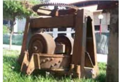
De la Whiting Foundry Company, era utilizado en el Taller de Fundición para preparar las arenas y aditivos a utilizar en el moldeo de las diversas piezas de madera para vaciar el fierro, cobre o latón líquido según fuese la operación a realizar. Para formar el barro era necesario realizar una mezcla consistente de arcilla, agua, alquitrán y cisco de coque, una vez listo, se recubría el molde a utilizar para efectuar el proceso de vaciado.
