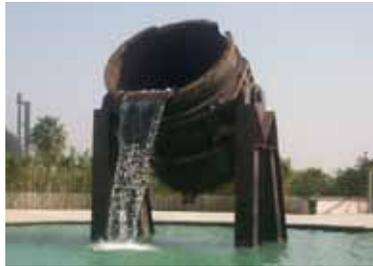
Adquirida por Fundidora Monterrey y utilizada en el Departamento de Aceración N° 2, se recubría interiormente de ladrillo refractario para ser sometida a una operación de secado y eliminar toda humedad antes de recibir el acero líquido. En la parte inferior de la olla, hay una boquilla por donde se vertía el acero fluido a las coquillas. El peso de esta olla con revestimiento de ladrillo refractario era del orden de los 92,000 kgs.
