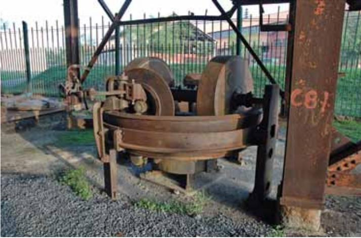
Molino mezclador para la fabricación de barro refractario.
