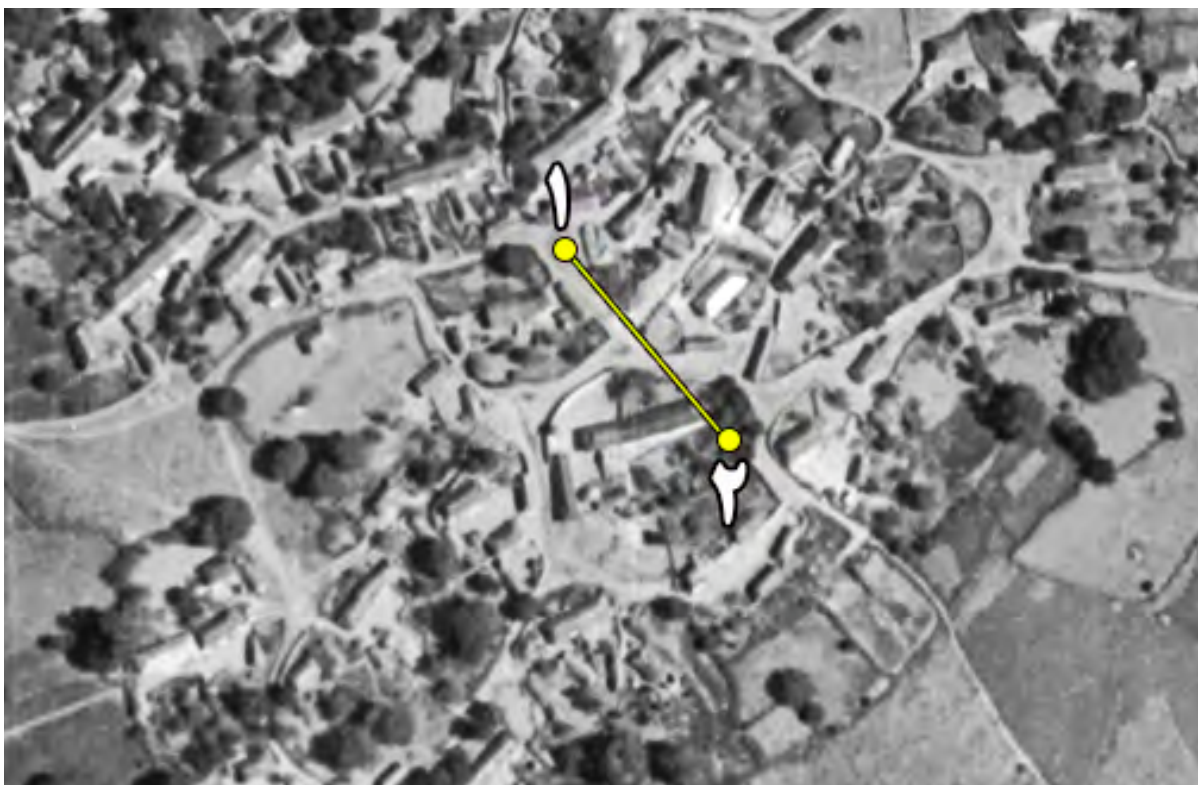
تصویر شماره ۱۰: جانمایی قنات روستای تلاوک، بر مبنای تصویر هوایی سال ۱۳۴۶ خورشیدی. نقطه شماره ۱: جایگاه مادرچاه قنات؛ نقطه شماره ۲: جایگاه مظهر قنات. منبع: سازمان نقشه‌برداری (ترسیم از نگارنده).
