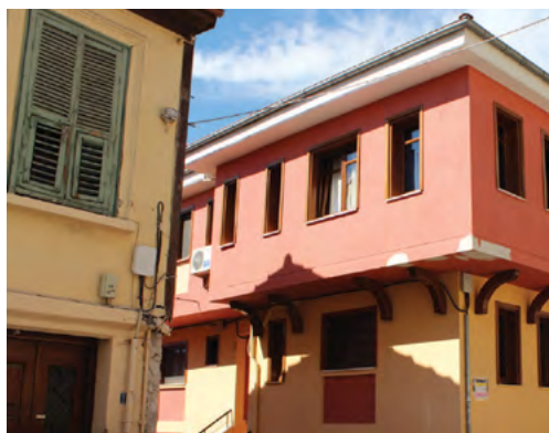
تصویر شماره ۴: یک ساختمان جدید بدون عناصر سایه زنی بیرونی تابش مستقیم خورشیدی را از طریق سطوح شفاف نما دریافت می کند، در کنار آن یک ساختمان مسکونی بومی با عناصر سایه انداز در شهر فوقانی تسالونیک (محقق، ۲۰۱۳).
