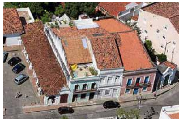
Foto 9: Sobrado apresentando interrupção das águas frontal e posterior do telhado, sem alteração da morfologia das empenas (Fonte: www.olinda.pe.gov.br).
