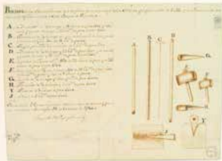
"Herramientas que se piden para el trabajo de las minas que [...] se han de beneficiar en este Nuevo Reyno de Granada". (Barrenos, Atacadores, Abujas, Barretas, Combas, Cuiñas, Famulias, Azadones, Palas).
