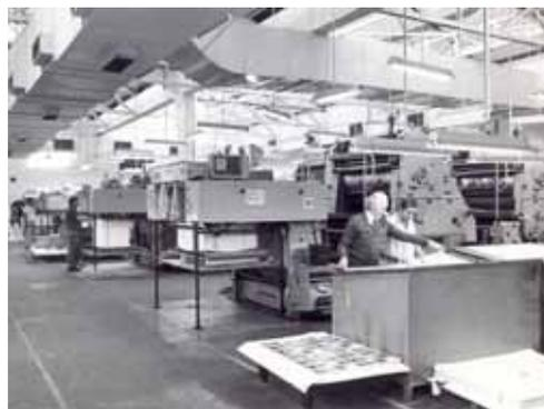
**Fig. 91 J:** CMSP, em primeiro plano máquina *Rolland* (impressão a 4 cores), década de 1970. Fonte: Acervo da empresa
