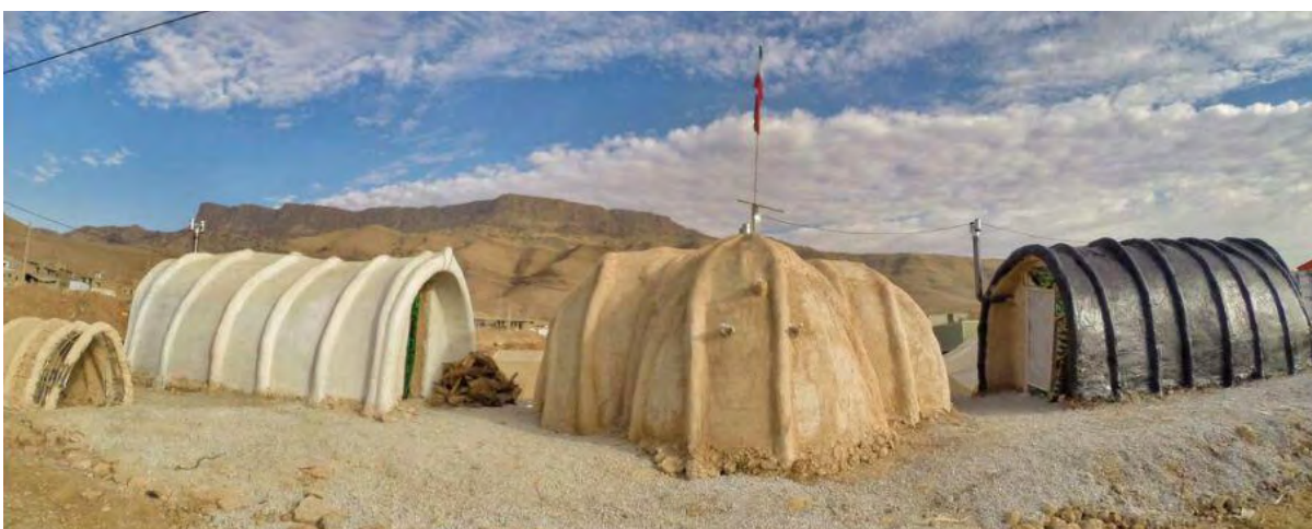
تصویر ۱۱- تست عایق‌های مختلف برای کومه‌ها. راست: عایق کاری با امولسیون قیر؛ وسط: پیش از عایق کاری؛ چپ: عایق کاری با نوعی عایق صنعتی منبع: نگارنده.
