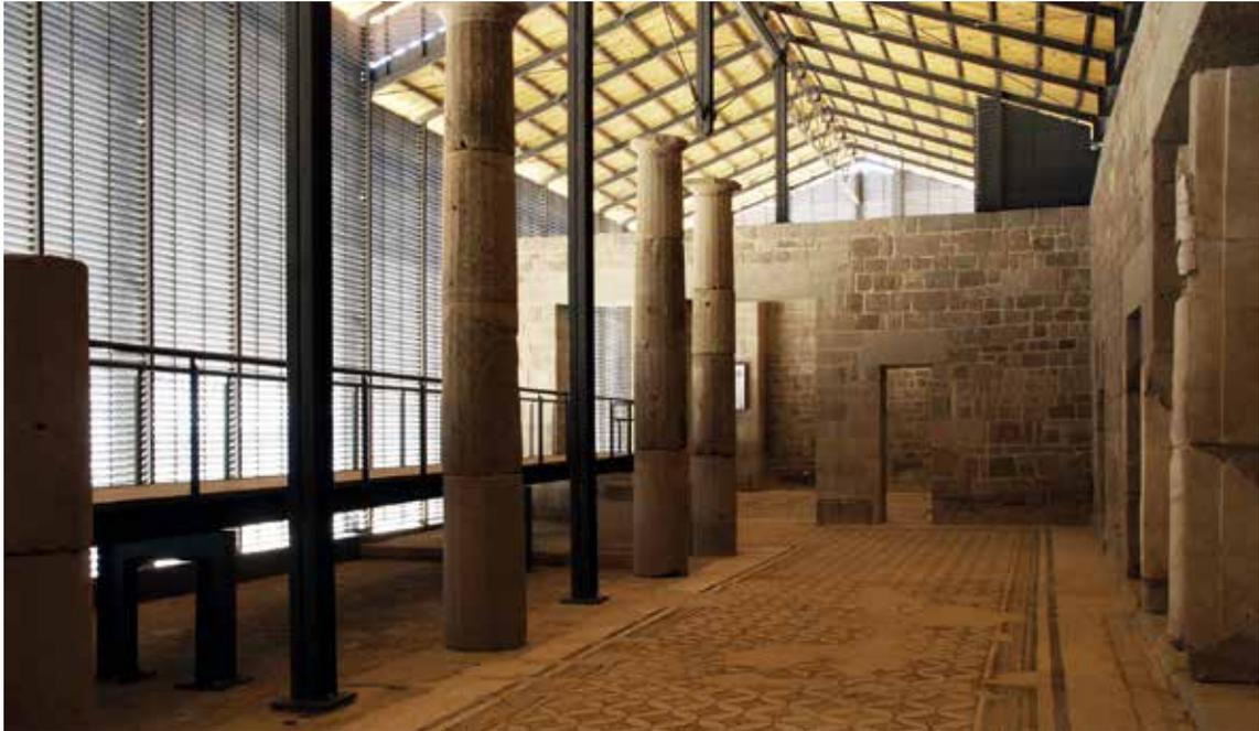
11 Pergamon, Bau Z, Inneres des Schutzbaus mit der gedämpften Lichtwirkung der Lamellen und den Besucherstegen.
