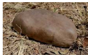
Pierre polie servant à lisser la dalle
