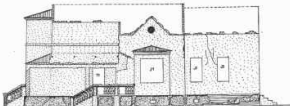
LEGENDA TRAMA DO AZUL (SANTO) ALGUM RESTAURADO ALGUM LATERAL BRUTO — LEVANTAMENTO 1/50 TRAMA DO AZUL TRAMA A SER RESTAURADO TRAMA DO BRANCO TRAMA A SER RESTAURADO JANELA TRAMA DO BRANCO TRAMA A SER RESTAURADO PORTA
