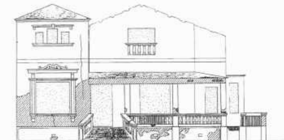
ALÇADO ESCALA 1:50 TRAMA DO AZUL (SANTO) TRAMA A SER RESTAURADO TRAMA DO AZUL TRAMA A SER RESTAURADO TRAMA DO BRANCO TRAMA A SER RESTAURADO TRAMA DO BRANCO TRAMA A SER RESTAURADO
