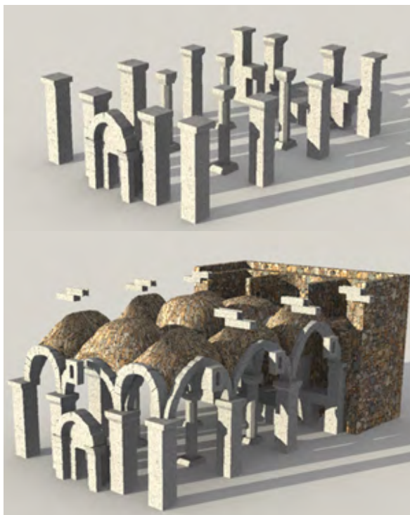
تصویر شماره ۶: بررسی عناصر باربر و غیر باربر در کلیسای مادر مقدس، روستای گریس. تصویر بالا عناصر باربر اصلی را نشان می‌دهد که از سنگ تراشیده ساخته شده‌اند و تصویر پایین عناصر غیر باربر که بسته به اهمیت بنا، می‌توانند از سنگ لاشه یا آجر ساخته شوند. ساخت ماکت سه‌بعدی توسط نگارنده.
