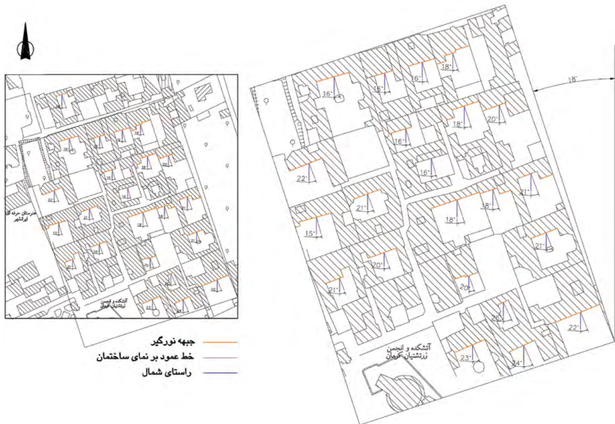
تصویر شماره ۲: نمایش جهت چرخش ساختمان در بافت زرتشتی‌نشین (محل آتشکده کرمان).
