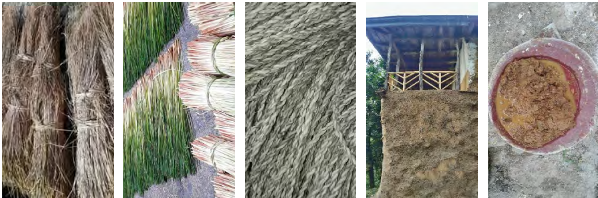
تصاویر شماره ۵۳ تا ۵۷: نمونه‌ای از مصالح مورد استفاده گیاهی و معدنی در خانه‌های بومی گیلان: از راست ملات فل و گل، نمونه پوشش کاه‌گل در نمای بیرونی، طناب الیاف طبیعی (پریس/ وریس)، دسته‌های گیاه گالی، دسته‌های کلوش.
