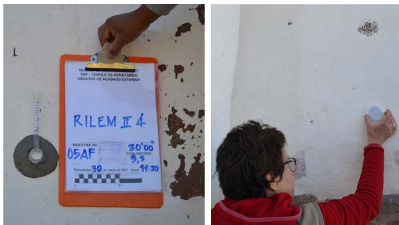
Figura 5 – Ejecución de las pruebas de evaluación de las muestras en mayo 2021: prueba de adhesión por puntero acústico (izquierda), prueba de absorción de agua a baja presión RILEM II.4 (centro) y prueba de porosidad abierta por esponja de contacto UNI 11432 (2011) (derecha). Fotografías Luís Villacorta Santamato © 2021, J. Paul Getty Trust
