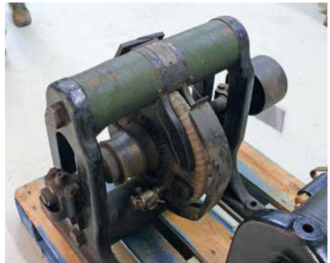
Abb. 15: Dynamomaschine der Fa. Schuckert, 1875 (Deutsches Museum)
