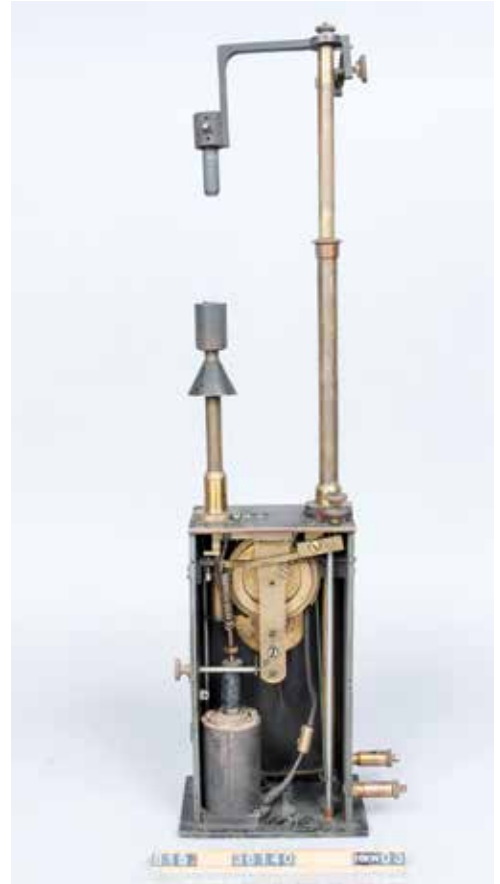
Abb. 4: Bogenlampe, System Schuckert (Inv.-Nr. 36140)
