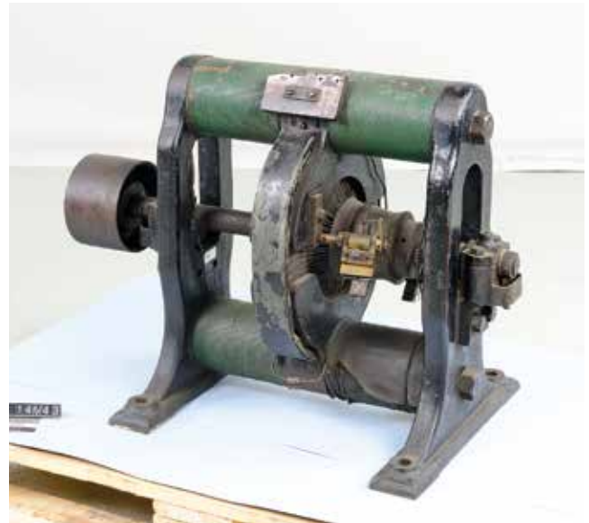
Abb. 8: Dynamomaschine, System Schuckert (Inv.-Nr. 36147)
