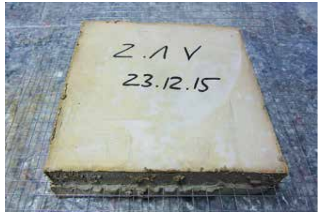
Abb. 15: Musterplatte Serie 2 mit Punktschweißgitter
