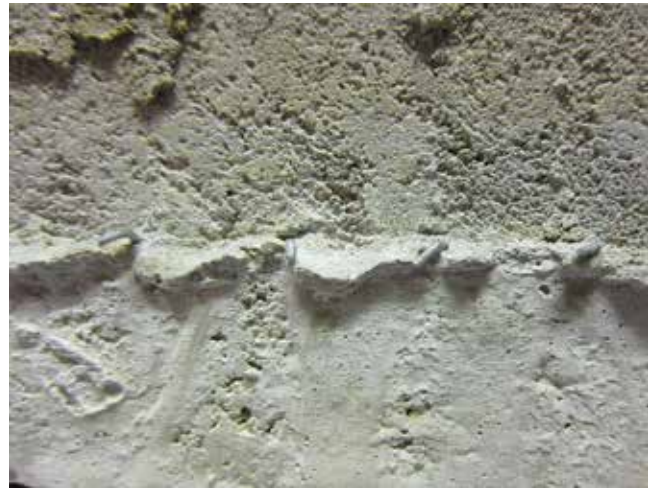
Abb. 17: Querschnitt einer Musterplatte Serie 3 mit starkem Haftverbund durch die Romanzementschlämme
