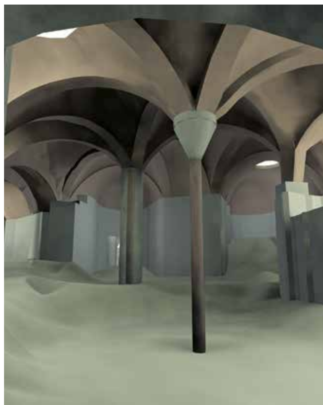
Abb. 4: Modell des Innenraums der Grotte ohne eingehängte Drahtputzschale, Blick vom Grottensee nach Norden auf die beiden Gusseisensäulen – im Vordergrund die Seesäule, im Hintergrund die nachträglich ummauerte Säule mit der Beleuchterkanzel
