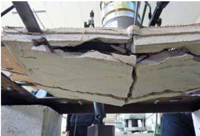
Abb. 14: Druckfestigkeitsprüfung an Musterplatte Serie 1
