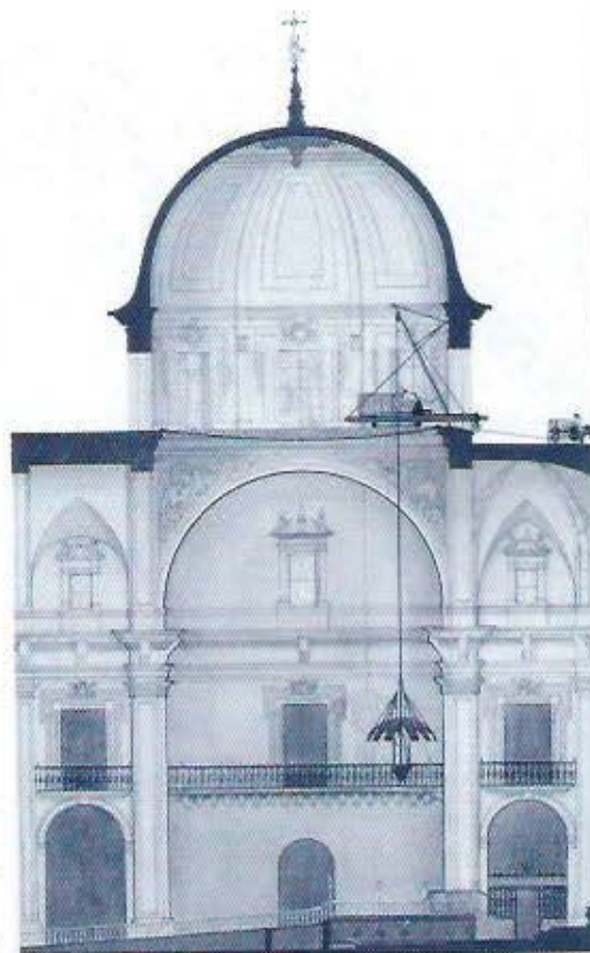
Sección en alzado de la Basílica de Santa María de Elche, delineada por el arquitecto ilicitano Antonio Serrano Peral (1945), que muestra la ubicación de las tramoyas alta y baja que sustentan la dimensión escénica horizontal (terrestre) y vertical (celeste) de la Festa d'Elx. En el Misterio de Elche, patrimonio tangible, mueble e inmueble, y patrimonio intangible constituyen indudablemente las dos caras de la misma moneda. Por cortesía de la Junta Rectora del Patronat del Misteri d'Elx.
