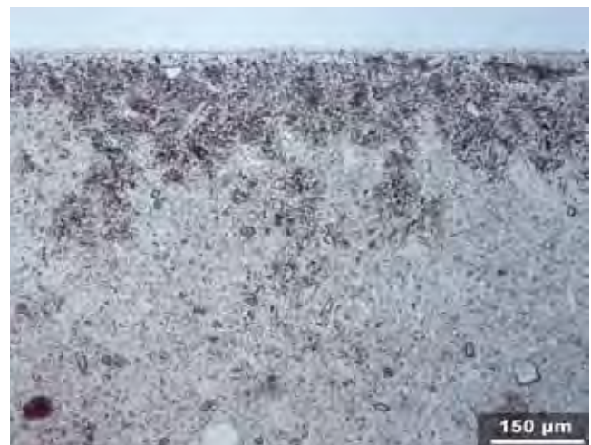
Abb. 5: Mikroskopische Aufnahme eines Dünnschliffes, Probekörper nach dem Eintrag von Feuchte von hinten mit Zugabe eines Salzes
