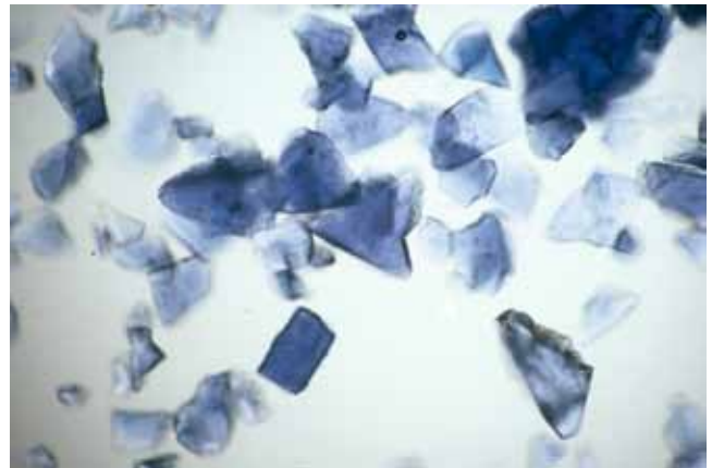
Abb. 9: Smalte, Aufnahme im Durchlichtmikroskop, (Vergrößerung 100x)
