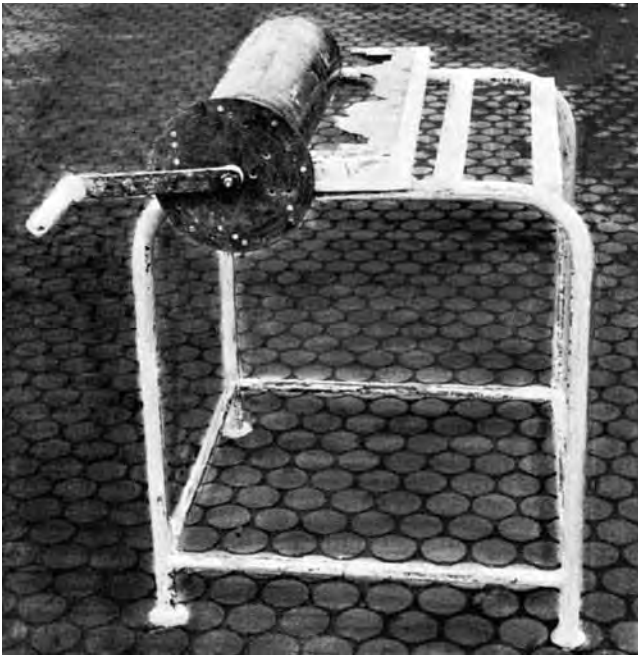
Abb. 7: Arbeitstisch zum Drehen von Säulen oder Balustern
