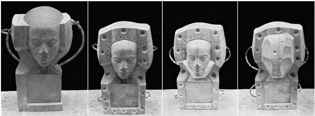
Abb. 12: Entstehung einer Gipsstückform
