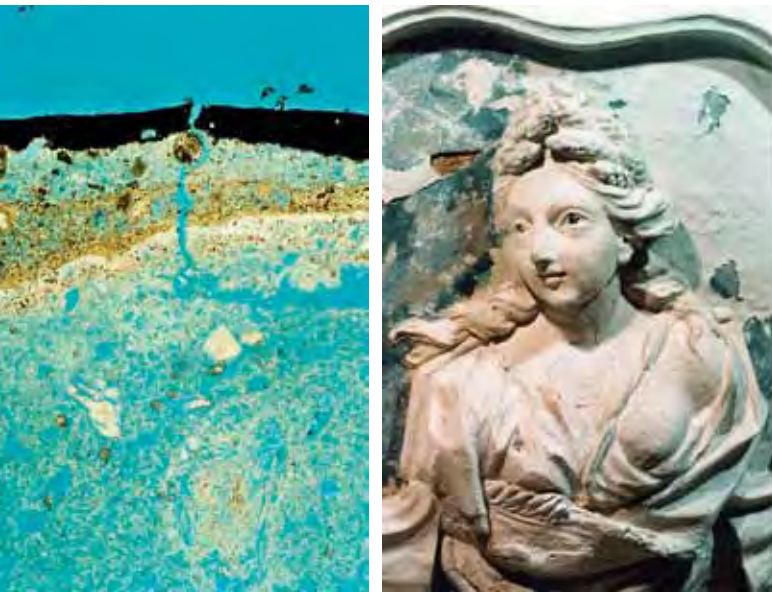
Abb. 10: Trier, Haus Venedig, links Allegorie des Sommers (Foto: Vohland, 2003), links Dünnschliffaufnahme des Stucks (Bildbreite ca. 0,9 mm)
