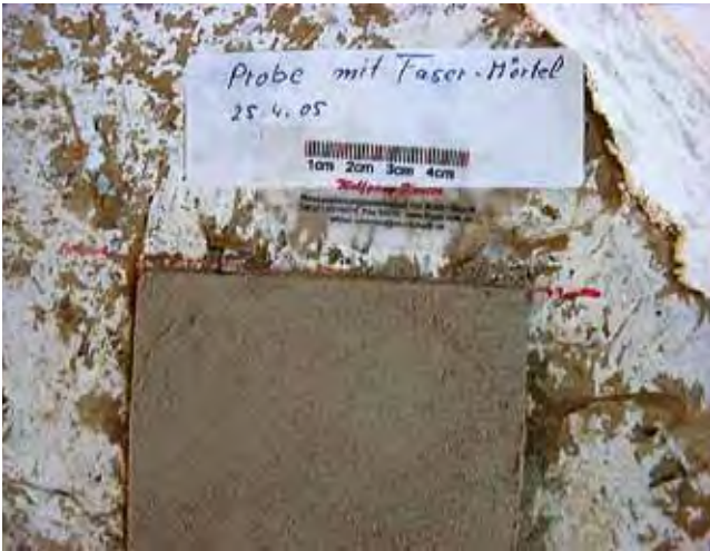
Abb. 19: Antragung von Kalkputz mit Faserzugabe
