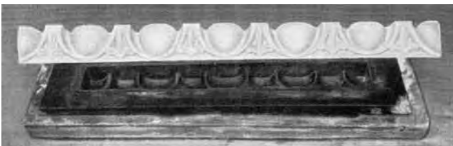
Abb. 14: Flexible Form mit Stützmantel
