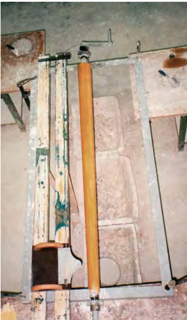
Abb. 9: Drehtisch zur Erstellung einer gewendelten Säule
