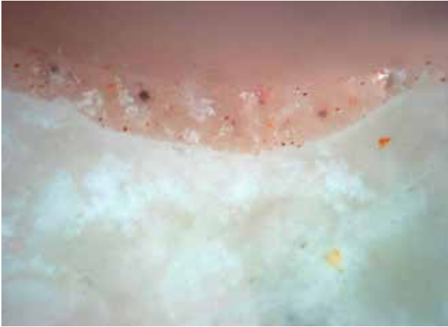
Abb. 18: Freising, Dom St. Maria und St. Korbinian, Querschliff der bauzeitlichen hellroten Stuckfassung
