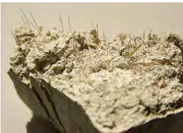
Abb. 9: Putzprobe mit körniger Matrix und eingebetteten Fasern
