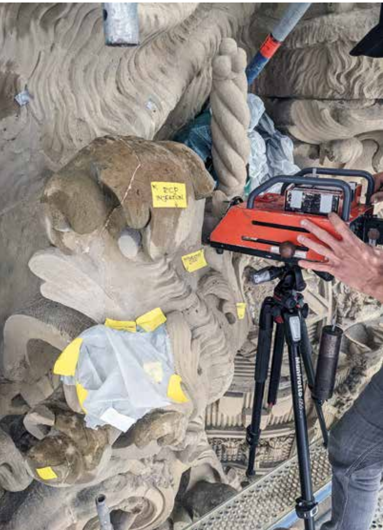
Abb. 12 Messungen des Bohrwiderstandes an Musterflächen zur Haftung von Ergänzungs- und Injektionsmörtel (Foto S. Ploner, Bayerische Schlösserverwaltung, 2020)
