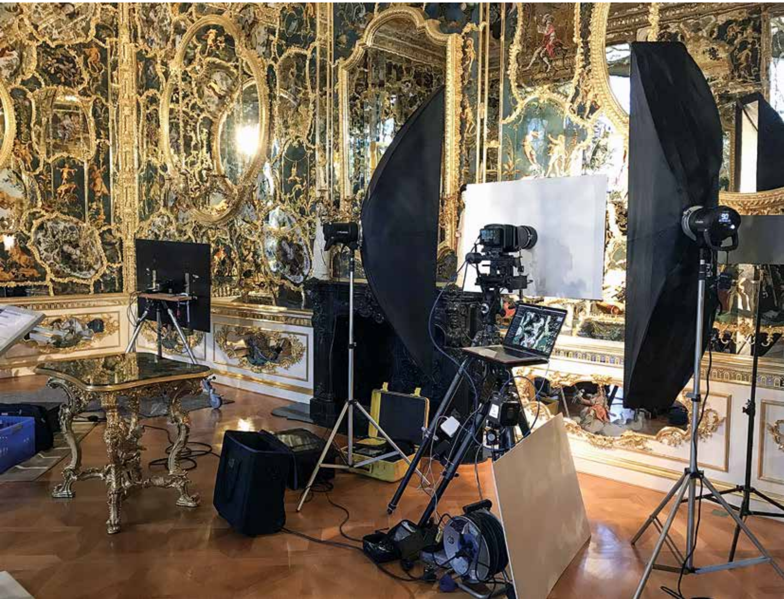
Abb. 6 Fotogrammetrische Probeaufnahmen im Spiegelkabinett der Würzburger Residenz (Foto Bernhard Strackenbrock)
