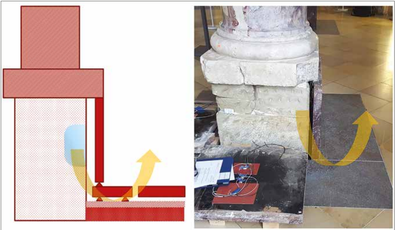
Abb. 4 Schematische und bildliche Darstellung der Baukonstruktion sowie Konvektionsströmung an Säule Nr. 5 (Grafik S. Ploner, Bayerische Schlösserverwaltung)
