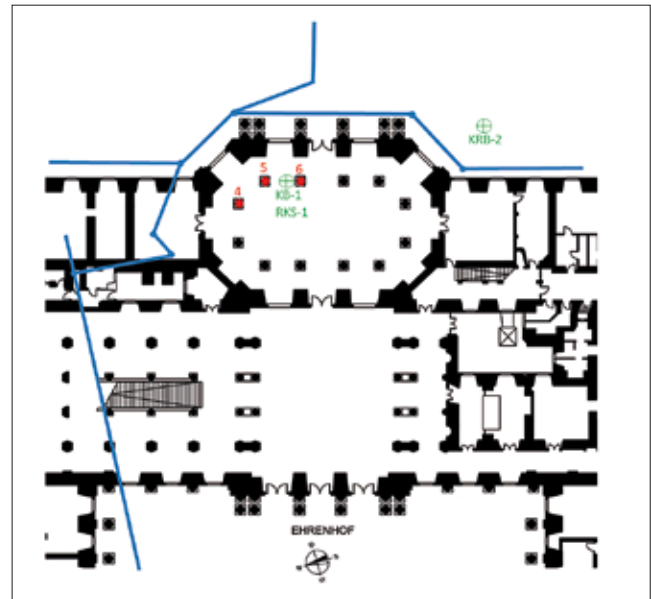
Abb. 3 Grundriss des Gartensaal und Umgriff; rot = nummerierte Säulen; grün = Lokalisierung Bohrkernentnahmen; blau = schematischer Verlauf des Kanals (Plan S. Ploner, Bayerische Schlösserverwaltung)
