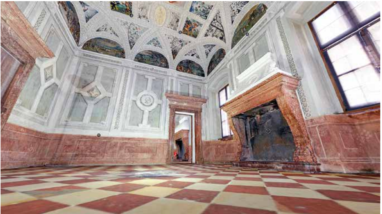
Abb. 5 Stadtresidenz Landshut. Modelle für Virtual Reality (VR) können oft auf den ersten Blick beeindruckend sein. Die hinterlegte Geometrie ist aber meist auf unter 1% der ursprünglichen Informationen ausgedünnt und auch für die Textur werden nur wenige Prozent der Originalauflösung verwendet (Foto Bernhard Strackenbrock)
