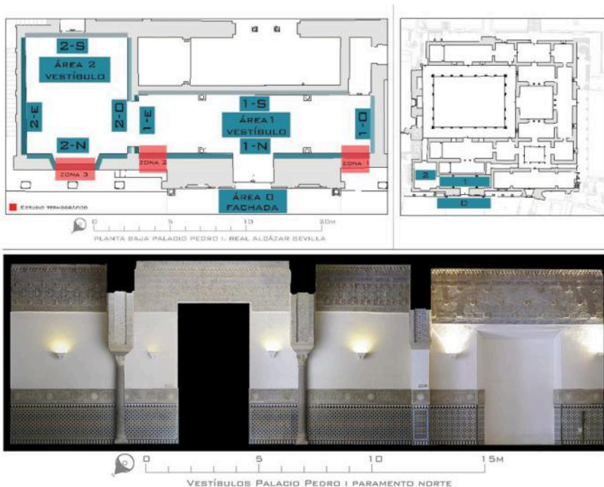
fig 1. Zona superior Plano ubicación y áreas de estudio termográfico. Modificado a partir del levantamiento realizado por el Dr. Antonio Almagro. Zona inferior: ortofoto paramento 1N-2N (elaboración propia, 240 ppp).
