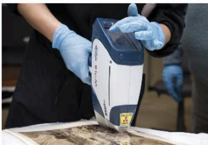
Fig 2. Aparato XRF Portátil S1 TITAN Bruker. Los resultados previos confirmaron la presencia de metales preciosos empleados en los procesos de virado de albúminas, como el oro y el paladio, comúnmente utilizados en la época. Fotografía: Inês Domingues y Mónica de Sousa.
