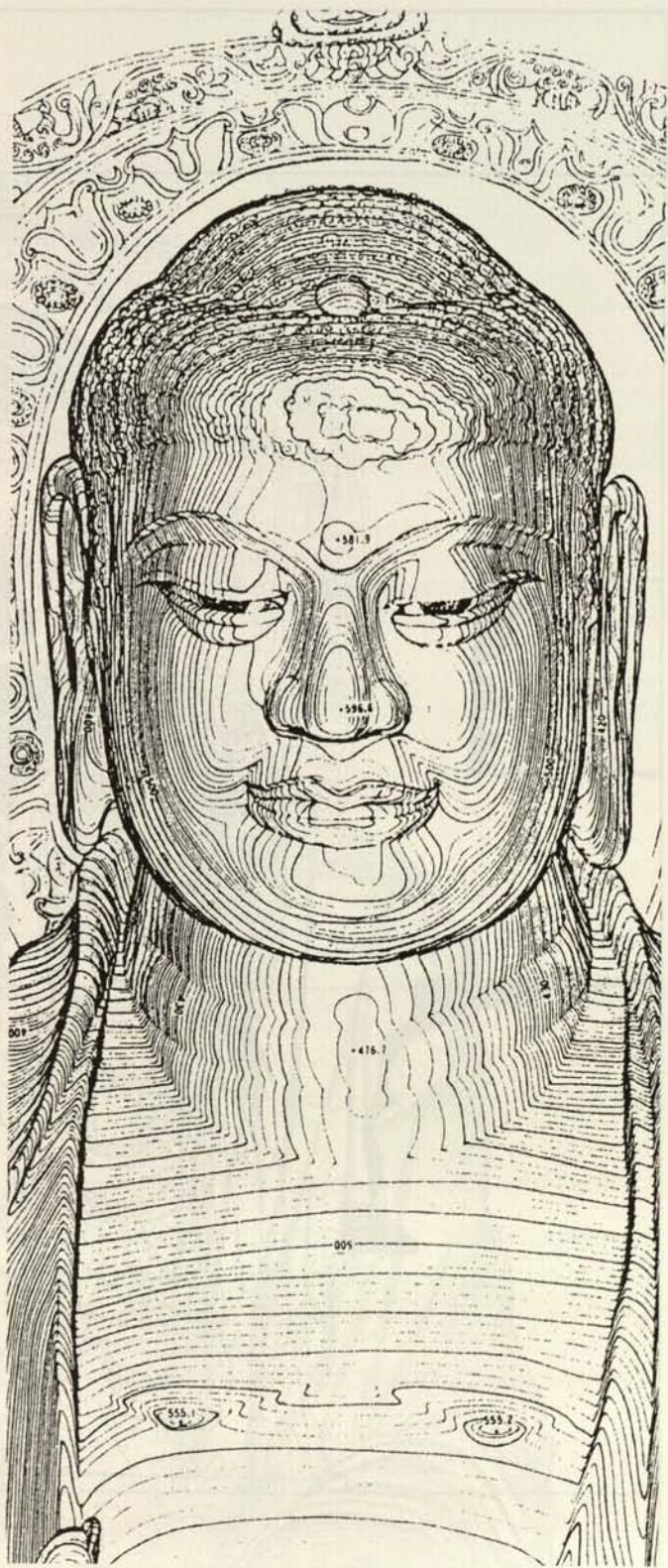
Abb. 1. Großer Buddha; photogrammetrische Aufnahme von Kopf und Brust mit Kartierung der Höhenlinien; Technisches Zentrum für Denkmalpflege Xi'an, Provinz Shaanxi, 1984
