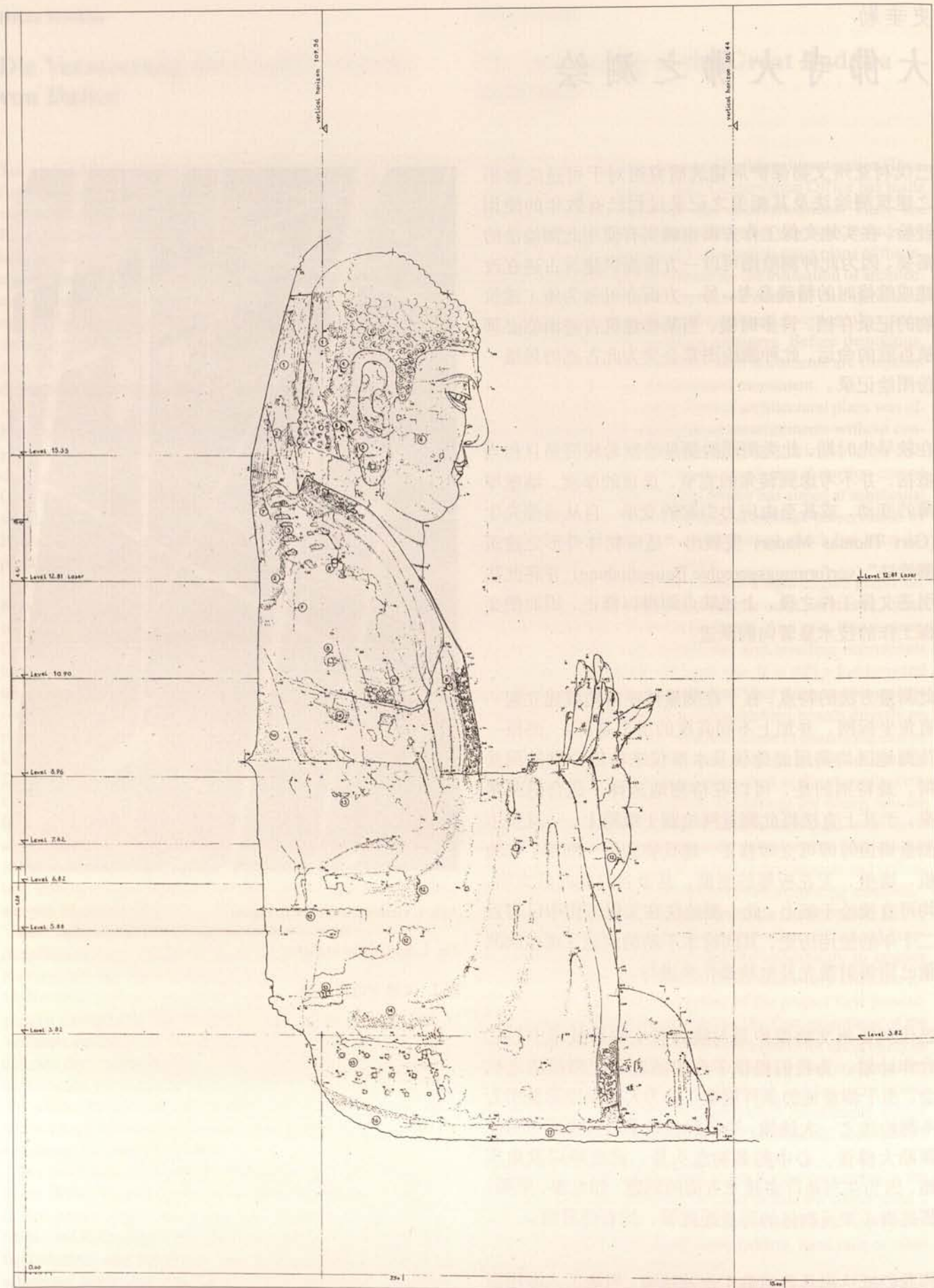
Abb. 2. Verformungsgerechtes Aufmaß des Großen Buddha von Dafosi; Seitenansicht
