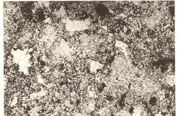
Abb. 31. Mikrofotographie einer Stuckprobe aus Khirbet-al-Mafjer: Ausschnitt mit der teilweise auflösbaren Gipsmatrix (gebündelte Struktur aus tabellarisch geordneten Gipskristallen) und geringem Anteil an Zuschlagstoffen (d = 3 mm).
