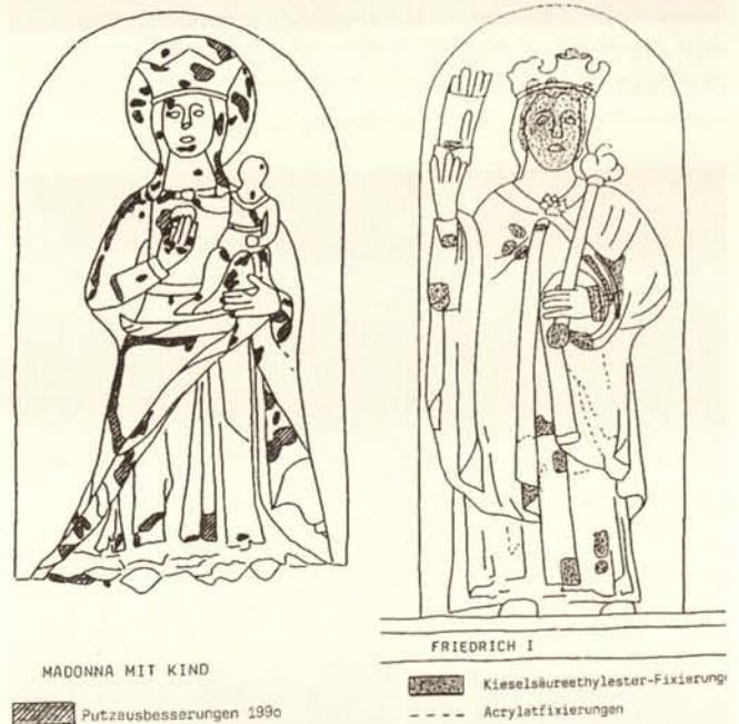
Abb. 192 a-b. Goslar, Vorhalle der ehem. Stiftskirche St. Simon und Juda, Dokumentation der Konservierungsmaßnahmen, Ausschnitt: Kartierung von Kalkmörtelergänzungen (a) und eingebrachten Fixierungsmaterialien (b).
