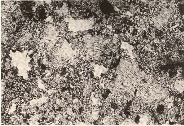
Abb. 26. Mikrofotographie einer Stuckprobe aus dem sog. Tempietto von Cividale: Ausschnitt mit geringem Anteil von Zuschlagstoffen (feinem Sand, Ziegelsplitt, gemahlenem Marmor) sowie der optisch nicht auflösbaren Gipsmatrix (d = 3mm).
