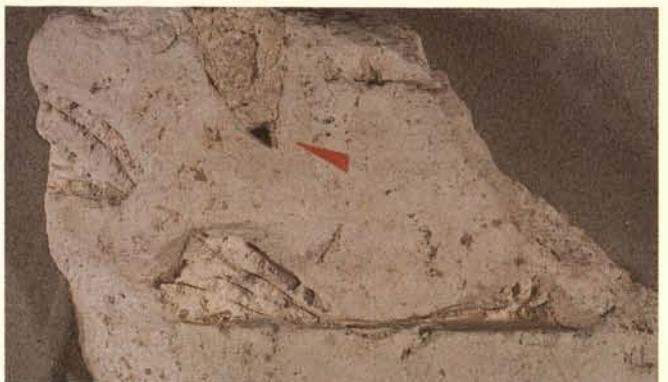
Abb. 149. Stuttgart, Landesdenkmalamt, Stuckfragment aus der ehem. Klosterkirche Großkornburg (Mag.-Nr. 407/408), Detail mit Staubablagerungen in den Vertiefungen geschlossener Ornamente: Beleg für Veränderung noch vor der ersten Farbfassung.
