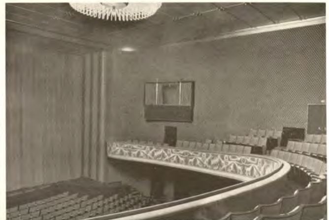
Abb. 7. Blick in den Zuschauerraum des wiederaufgebauten Residenztheaters. Das dreifach gestufte, variable Bühnenportal und die aus beweglichen Elementen gebildete Decke, hinter der sich Lichttechnik verbarg, galten als große technische Errungenschaft. Die hufeisenförmige Rangbrüstung deutet den Verlauf der hier einst eingebauten Logenfronten des François Cuvilliés an.
